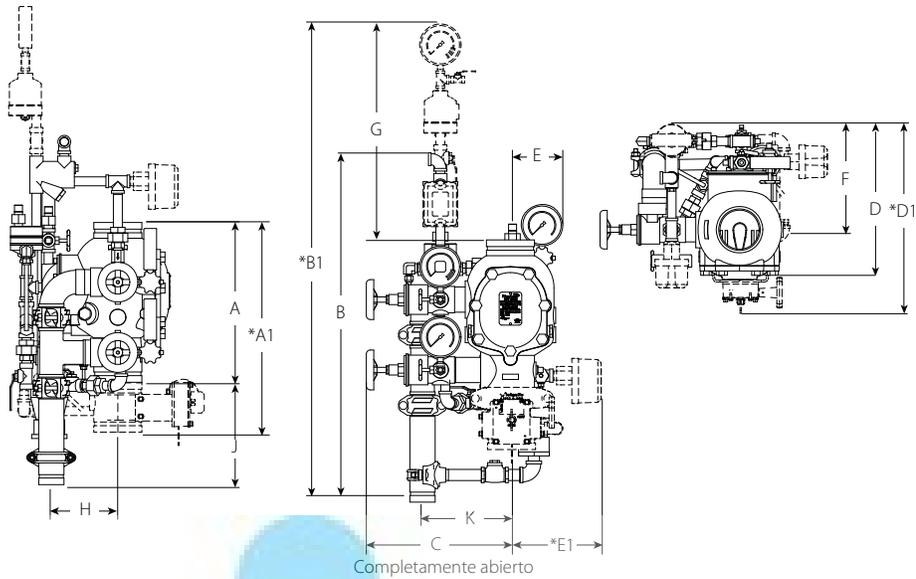
ARRIBA SE MUESTRA LA CONFIGURACIÓN DE 4"/100 mm CON CLASIFICACIÓN UL Y APROBACIÓN UL. LAS CONFIGURACIONES DE 1½ - 2"/40 - 50 mm INCLUYEN VÁLVULAS DE DRENAJE DE ¾"/20 mm. LAS CONFIGURACIONES DE 2½ - 3"/65 - 80 mm INCLUYEN VÁLVULAS DE DRENAJE DE 1¼"/32 mm. LAS CONFIGURACIONES DE 4 - 8"/100 - 200 mm INCLUYEN VÁLVULAS DE DRENAJE DE 2"/50 mm.
