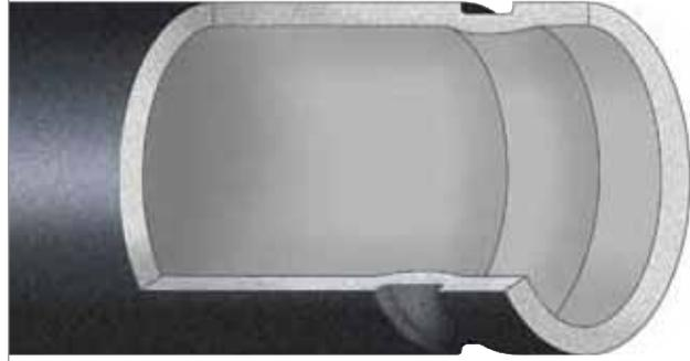
En la ilustración se muestra una ranura laminada en una tubería de acero Cédula 40. El pequeño surco que queda en la pared interior de la tubería no afecta de manera significativa a la presión o el caudal.
