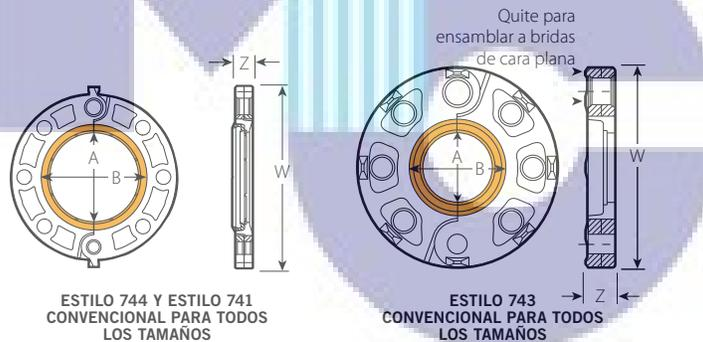
Para un sellado eficaz, el área anaranjada de la cara acoplada no debe tener perforaciones, ondulaciones ni deformidades de ningún tipo.
