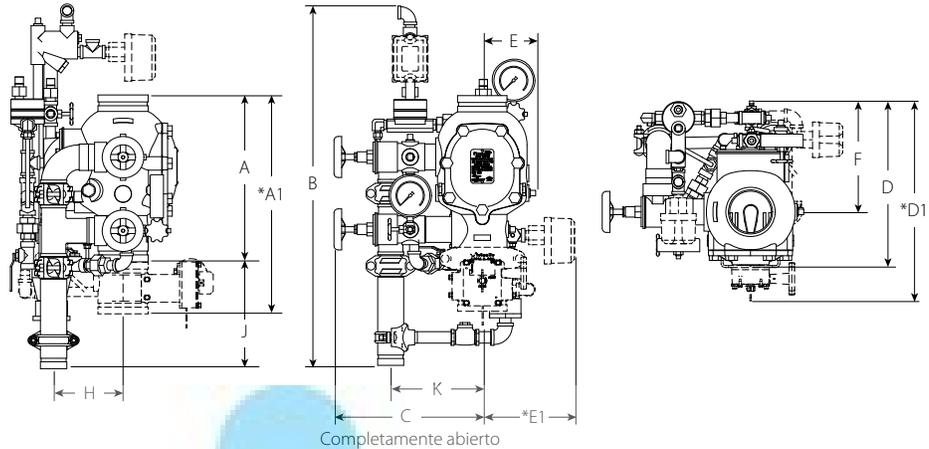
ARRIBA SE MUESTRA LA CONFIGURACIÓN CON PILTO SECO DE 4"/100 mm
